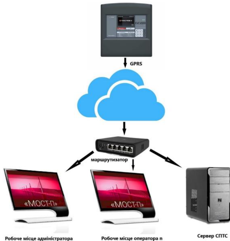
Рис. 1 – Структурна схема системи централізованого спостереження для ведення пожежного моніторингу по комутованих телефонних лініях і по GSM-каналу з використанням СПТС "МОСТ-П".
