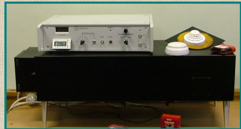
Установка для випробування теплових та димових сповіщувачів РОСТОК-ВЦ
