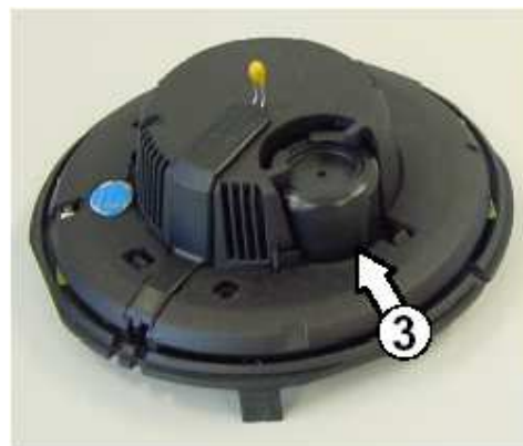
Рисунок 3. Розміщення чутливих елементів сповіщувача: 3 – датчик чадного газу.
